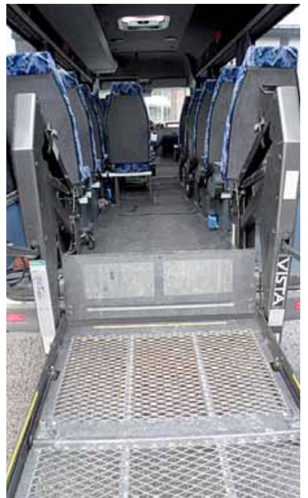
Pyörätuolin nostaminen bussiin sujuu turvallisesti ja vaivattomasti tarkoitukseen asennetulla hissillä.
