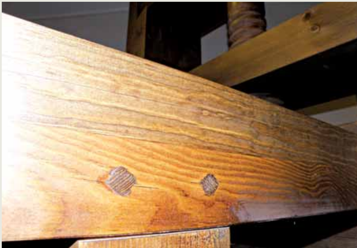
Tyrvääläisittäin mielenkiintoinen yksityiskohta painokoneessa: Pyhän Olavin kirkon rakenteista lähtöisin olevat puunaulat vahvistavat liitoksia.
